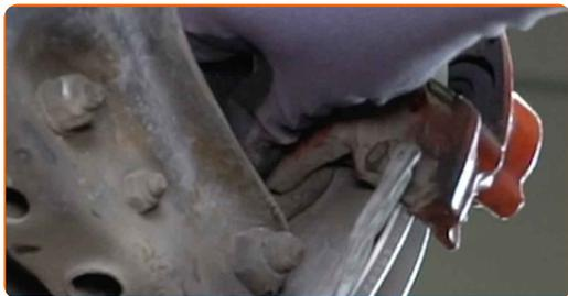
**30** Serra gli elementi di fissaggio della pinza del freno. Utilizza una chiave a bussola N°17. Usa una chiave dinamometrica. Serralo fino allo coppia di torsione di 65 Nm.
