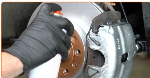
Sostituzione: pinza de freno - MERCEDES-BENZ Classe C T-modell (S202). Gli esperti di AUTODOC raccomandano:
