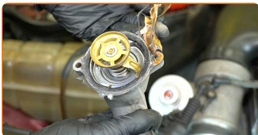
**21** Pulire la sede di montaggio dell'alloggiamento del termostato. Usa una spazzola metallica. Usa un detergente spray multiuso.
