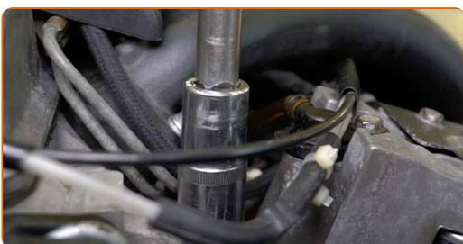
**35** Applicare un prodotto trattante sul connettore del sensore di temperatura del refrigerante. Usa il grasso al silicone.
