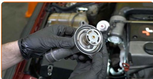
**25** Installare il termostato insieme all'alloggiamento.
