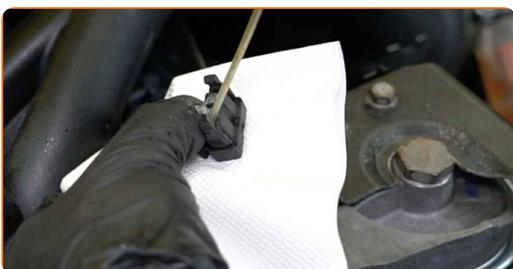
**36** Inserire il connettore del sensore di temperatura del fluido di raffreddamento.
