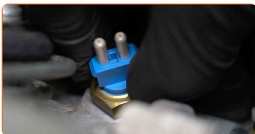
Sostituzione: sensore di temperatura e termostato refrigerante - MERCEDES-BENZ Classe C Sedan (W202). Il consiglio degli esperti di AUTODOC:
