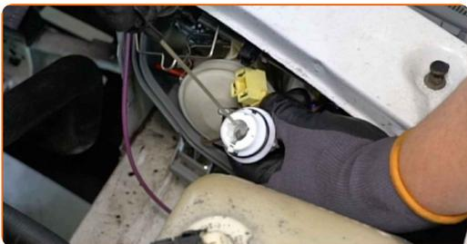
**13** Installare una nuova lampadina dell'indicatore di direzione nell'apposita presa.
