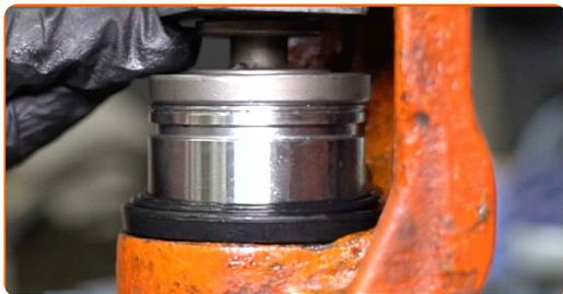
**39** Installare la piastra protettiva del soffietto parapolvere del pistone della pinza.
