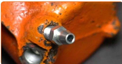
**45** Pulire il punto in cui il tubo flessibile del freno si collega alla pinza. Usa una spazzola metallica. Usa un detergente spray multiuso.
