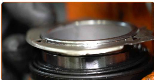
**40** Premere il pistone della pinza del freno. Usa un arretratore per pistoncini freni a disco.
