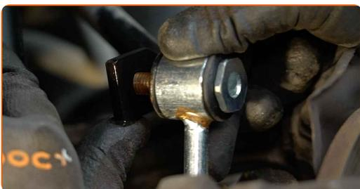
**13** Sorreggere il fuso a snodo posteriore. Usa un cric idraulico per trasmissione.
