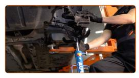
Installa e stringi il bullone nuovo del fuso a snodo. Utilizza una chiave a bussola N°19. Utilizza una chiave combinata N°19. Usa una chiave dinamometrica. Serralo fino allo coppia di torsione di 105 Nm.
