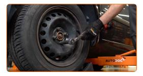
Serrare il fissaggio superiore del supporto di ammortizzazione. Utilizza una chiave a bussola N°13. Usa una chiave dinamometrica. Serralo fino allo coppia di torsione di 21 Nm.
