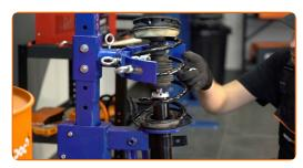
Installare il supporto di ammortizzazione nell'arco passaruota.
