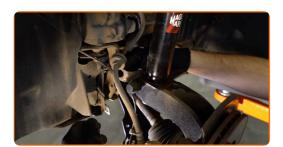
Fissare il puntone della barra stabilizzatrice trasversale sul supporto di ammortizzazione. Usa una chiave HEX N.H6. Utilizza una chiave combinata N°17. Usa una chiave dinamometrica. Serralo fino allo coppia di torsione di 44 Nm.
