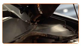
Rimuovi la copertura di protezione del parafango.
