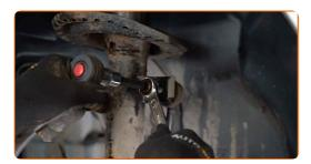
Pulisci gli elementi di fissaggio che collegano il puntone dell'ammortizzatore al fuso a snodo. Usa una spazzola metallica. Usa lo spray WD-40.
