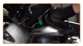
Solleva un poco la cuffia del supporto del puntone dell'ammortizzatore. Tratta con del prodotto gli elementi di fissaggio del supporto del puntone dell'ammortizzatore. Usa lo spray WD-40.
