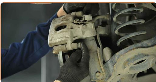
**25** Installare la molla di fissaggio della pinza freno. Usa un giravite piatto.
