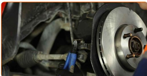
**10** Pulisci l'elemento di fissaggio che collega le testine tiranti al fuso a snodo. Usa una spazzola metallica. Usa lo spray WD-40.
