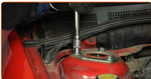
**41** Tratta con del prodotto gli elementi di fissaggio del supporto del puntone dell'ammortizzatore. Usa il grasso al rame.
