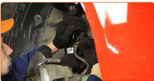
**51** Rimuovi il supporto da sotto il fuso a snodo.
