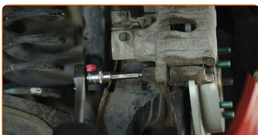
**47** Montare i tappi dei parapolvere delle guide pinza freno.
