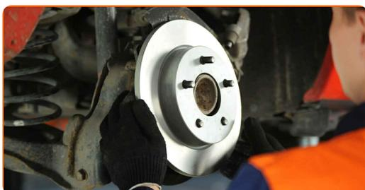
**18** Pulisci gli elementi di fissaggio del cuscinetto del mozzo ruota. Usa una spazzola metallica. Usa lo spray WD-40.
