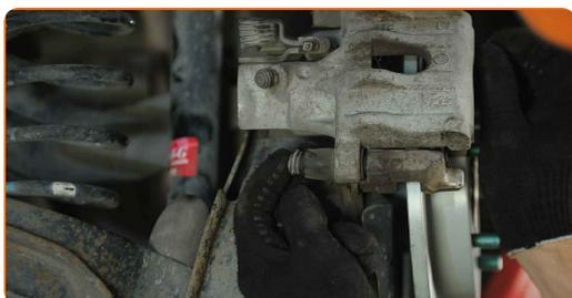
**48** Installare la molla di fissaggio della pinza freno. Usa un giravite piatto.
