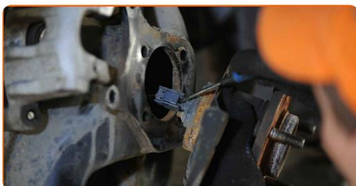
**23** Rimuovi la lamiera di protezione del disco freno.
