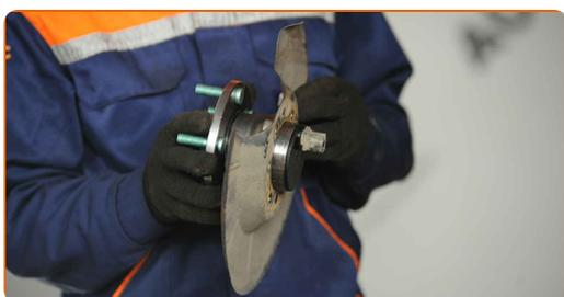
**32** Installare il cuscinetto del mozzo insieme alla piastra di protezione del disco freno.
