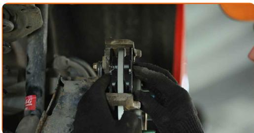
**46** Montare la pinza del freno e fissarla. Usa una chiave HEX N.H7. Usa una chiave dinamometrica. Serralo fino allo coppia di torsione di 30 Nm.
