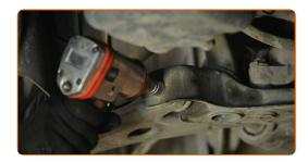
Rimuovi l'elemento di fissaggio frontale del braccio di sospensione.
