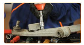
Montare e fissare il paracolpi sulla nuova leva di comando. Utilizza una chiave a bussola N°12. Usa una chiave dinamometrica. Serralo fino allo coppia di torsione di 19 Nm.
