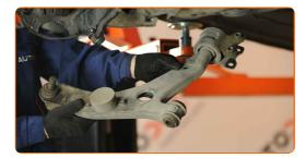
Svitare i supporti di fissaggio e rimuovere il paracolpi dalla leva di comando inferiore della sospensione anteriore. Utilizza una chiave a bussola N°12. Usa una chiave a cricchetto.
