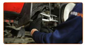
Pulisci l'elemento di fissaggio che collega il giunto sferico al fuso a snodo. Usa una spazzola metallica. Usa lo spray WD-40.
