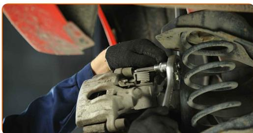
**35** Montare i tappi dei parapolvere delle guide pinza freno.
