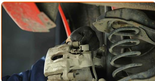
**36** Installare la molla di fissaggio della pinza freno. Usa un giravite piatto.
