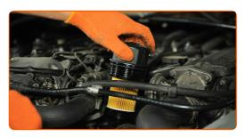
Avvitare il tappo. Usa la bussola 76-14F. Usa una chiave dinamometrica. Serralo fino allo coppia di torsione di 25 Nm.
