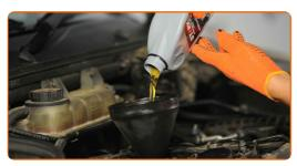
Sostituzione: olio motore e filtro - Mercedes ML W163. Il consiglio di AUTODOC:
