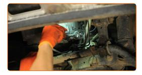
Pulisci la zona del foro di drenaggio della coppa dell'olio. Usa un detergente spray multiuso.
