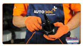
Installa i nuovi o-ring (3 pezzi) e il nuovo filtro dell'olio alle loro sedi di montaggio sul coperchio del filtro.
