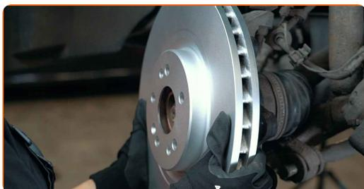
**19** Serrare l'attacco del disco freno. Usa una chiave HEX N.H5. Usa una chiave dinamometrica. Serralo fino allo coppia di torsione di 8 Nm.
