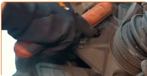
**12** Svitare l'attacco della staffa pinza freno. Utilizza una chiave a bussola N°22. Usa una chiave a cricchetto. Usa un giramaschi.
