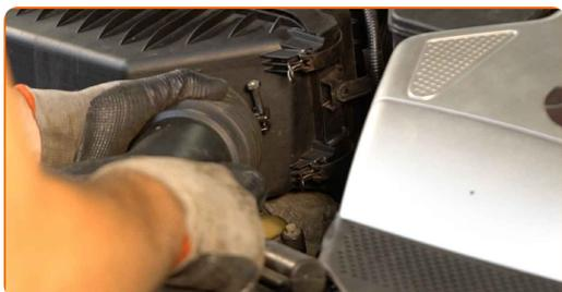
**101** Tieni saldamente gli elementi di fissaggio del condotto d'immissione dell'aria. Utilizza una chiave a bussola N°10. Usa una chiave a cricchetto.
