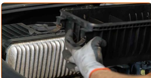
**10** Rimuovere dall'alloggiamento del filtro l'elemento filtrante da sostituire.
