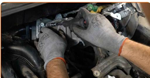
**74** Collega il tubo flessibile di ventilazione del carter motore al coperchio del motore a sinistra.
