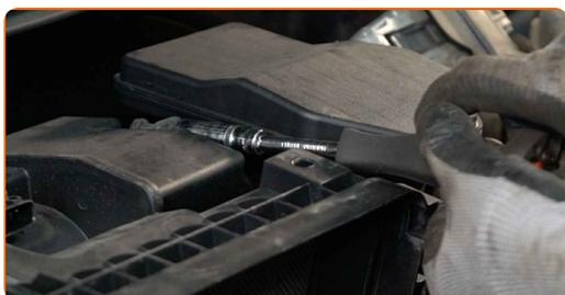
**18** Svitare i bulloni di fissaggio della carcassa del filtro. Utilizza una chiave a bussola N°10. Usa una chiave a cricchetto.
