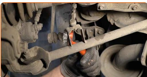
**7** Svita gli elementi di fissaggio che collegano il tirante della barra stabilizzatrice alla barra. Utilizza una chiave a bussola N°17. Usa una chiave a cricchetto.
