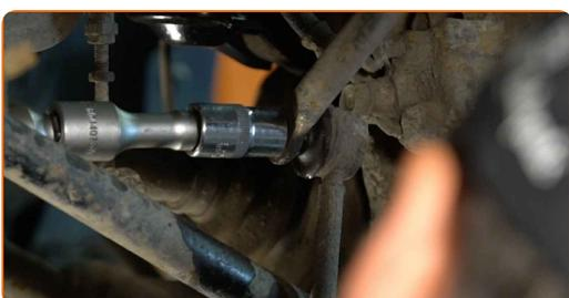
**8** Svita gli elementi di fissaggio che collegano il tirante della barra stabilizzatrice al puntone dell'ammortizzatore. Utilizza una chiave a bussola N°17. Usa una chiave a cricchetto.
