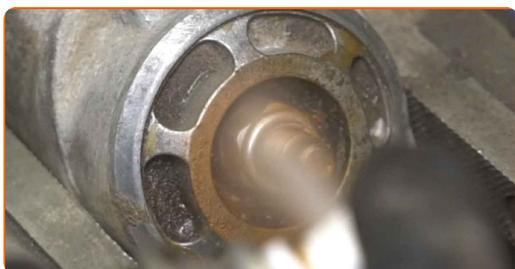
**21** Installare il coperchio di protezione della barra antiolio.
