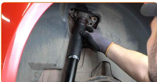
**25** Avvitare gli elementi di fissaggio del supporto dell'ammortizzatore. Utilizza una chiave a bussola N°16. Usa una chiave a cricchetto.
