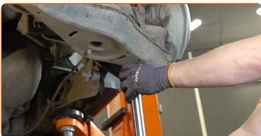
**8** Avvita l'elemento di fissaggio inferiore dell'ammortizzatore. Utilizza una chiave combinata N°21.
