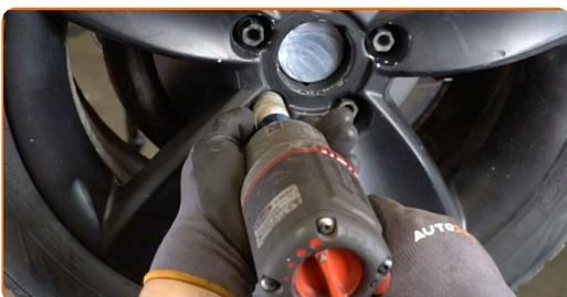
**37** Rimettere il veicolo per terra e, lavorando in ordine incrociato, serrare i bulloni di fissaggio delle ruote. Usa la chiave a bussola per dadi cerchio ruota n.17. Usa una chiave dinamometrica. Serralo fino allo coppia di torsione di 110 Nm.
