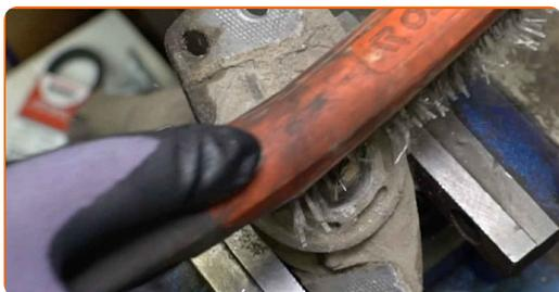
**16** Rimuovere l'elemento di fissaggio dell'asta pistone ammortizzatore. Utilizza una chiave a bussola N°16. Usa la chiave a bussola per ammortizzatore DDN°5,2. Usa una chiave a cricchetto.
