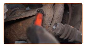
Svitare gli elementi di fissaggio del supporto della pinza del freno. Usa una chiave HEX N.H8. Usa una chiave a cricchetto.
