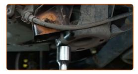
Svitare l'elemento di fissaggio del mozzo della ruota. Usa la chiave a bussola 12 punte n.30. Usa un giramaschi.
