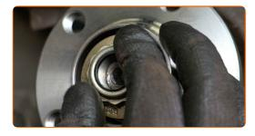
Serrare l'elemento di fissaggio del mozzo. Usa la chiave a bussola 12 punte n.30. Usa una chiave dinamometrica. Serralo fino allo coppia di torsione di 175 Nm.
