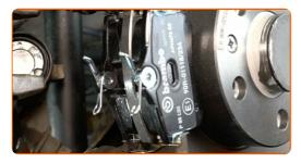
44 Installare la pinza del freno.
