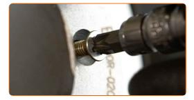
Stringere gli elementi di fissaggio del disco del freno. Usa un cacciavite Phillips. Usa una chiave dinamometrica. Serralo fino allo coppia di torsione di 4 Nm.
