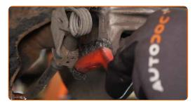
Svitare gli elementi di fissaggio della pinza del freno. Utilizza una chiave combinata N°13. Utilizza una chiave combinata N°15.
