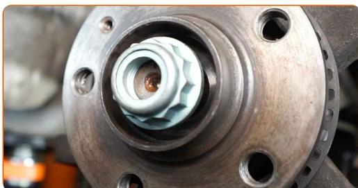
**66** Avvitare l'elemento di fissaggio del semiassie. Utilizza una chiave a bussola N°30. Usa una chiave a cricchetto.
