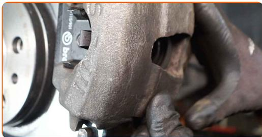
**78** Serra gli elementi di fissaggio della pinza del freno. Usa una chiave HEX N.H7. Usa una chiave dinamometrica. Serralo fino allo coppia di torsione di 28 Nm.
