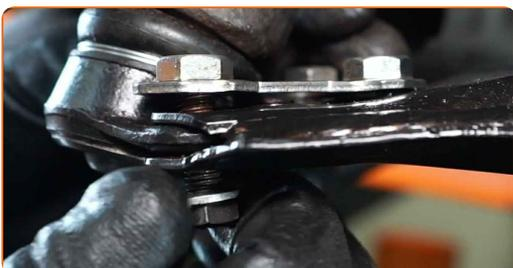
**60** Serrare gli elementi di fissaggio che collegano il giunto sferico al braccio della sospensione. Utilizza una chiave a bussola N°13. Usa una chiave a cricchetto.
