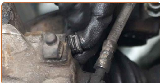
**80** Stringere gli elementi di fissaggio che collegano il giunto sferico al braccio di controllo. Utilizza una chiave a bussola N°13. Usa una chiave dinamometrica. Serralo fino allo coppia di torsione di 20 Nm. +90°
