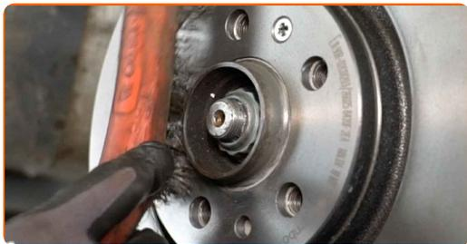
**14** Svitare gli elementi di fissaggio del disco del freno. Usa un cacciavite Phillips.
