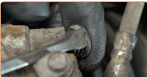
**11** Svitare gli elementi di fissaggio della pinza del freno. Usa una chiave HEX N.H7. Usa una chiave a cricchetto.
