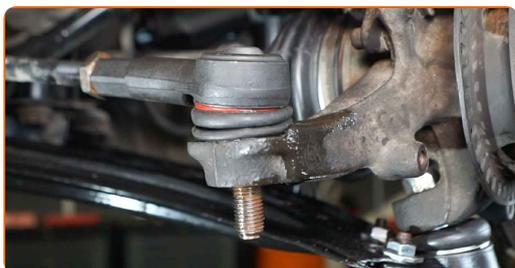
**70** Avvita il dado di serraggio che collega le testine tiranti dello sterzo al fuso a snodo. Utilizza una chiave a bussola N°19. Usa una chiave a cricchetto.
