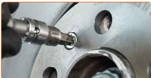
**75** Stringere gli elementi di fissaggio del disco del freno. Usa un cacciavite Phillips. Usa una chiave dinamometrica. Serralo fino allo coppia di torsione di 4 Nm.
