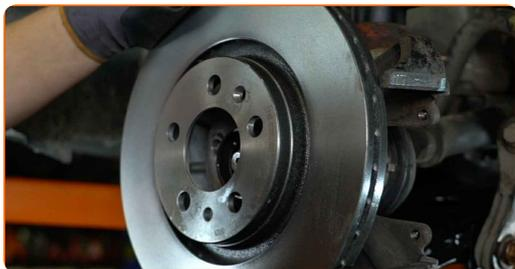
**17** Svita gli elementi di fissaggio che collegano l'albero di trasmissione al mozzo della ruota. Utilizza una chiave a bussola N°30. Usa una chiave a cricchetto.
