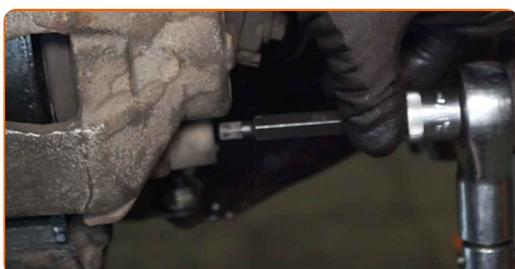
**79** Installare i tappi sui perni di guida delle pinze dei freni.
