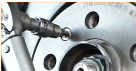
**76** Pulire il supporto della pinza del freno da sporco e polvere. Usa una spazzola metallica. Usa un pulitore freni.
