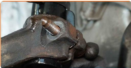
**57** Installare l'albero di trasmissione.
