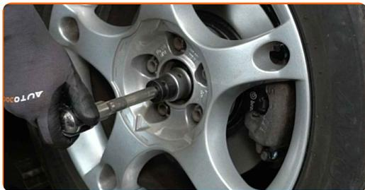
**5** Allentare i bulloni delle ruote. Usa la chiave a bussola per dadi cerchio ruota n.17. Usa un giramaschi.
