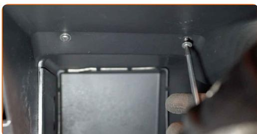
**13** Installa la copertura in plastica laterale. Posiziona il pezzo usando le guide e serra gli elementi di fissaggio.
