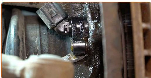
**11** Svitare l'attacco della pinza freno. Usa una chiave HEX N.H7. Usa una chiave a cricchetto. Usa un giramaschi.
