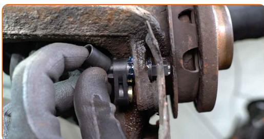
**21** Stringere l'elemento di fissaggio che collega il sensore ABS al fuso a snodo. Usa una chiave HEX N.H5. Usa una chiave dinamometrica. Serralo fino alla coppia di torsione di 6 Nm.
