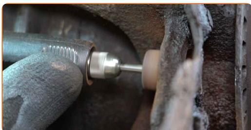
**19** Trattare l'elemento di fissaggio del sensore ABS. Usa un grasso multiuso.
