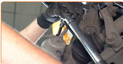
**28** Installare i tappi sui perni di guida delle pinze dei freni.
