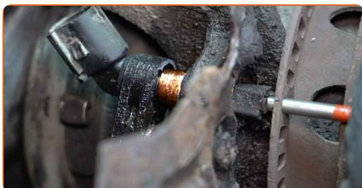
**18** Pulire la sede di montaggio del sensore ABS. Usa una spazzola metallica. Usa lo spray WD-40.
