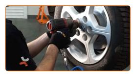
Rimettere il veicolo per terra e, lavorando in ordine incrociato, serrare i bulloni di fissaggio delle ruote. Usa una chiave dinamometrica. Serralo fino allo coppia di torsione di 108 Nm.
