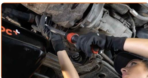
**18** Pulisci la zona del foro di drenaggio della coppa dell'olio. Usa un detergente spray multiuso.
