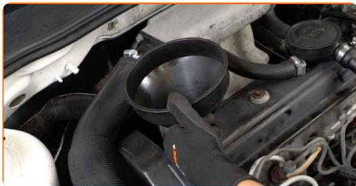
**22** Versa l'olio nel motore attraverso serbatoio. Quantità di olio richiesta:4.3 l.
