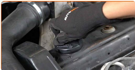
**26** Far funzionare il motore per qualche minuto. Dopo che la spia di segnalazione luminosa della pressione dell'olio sarà spenta, spegni il motore.
