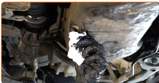
**17** Avvita il nuovo tappo di drenaggio e stringerlo. Utilizza una chiave a bussola N°19. Usa una chiave dinamometrica. Serralo fino allo coppia di torsione di 28 Nm.
