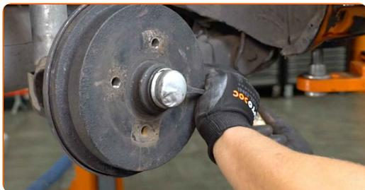
**8** Rimuovere la coppia di fissaggio del dado del mozzo. Usa un piede di porco. Usa un giravite piatto.
