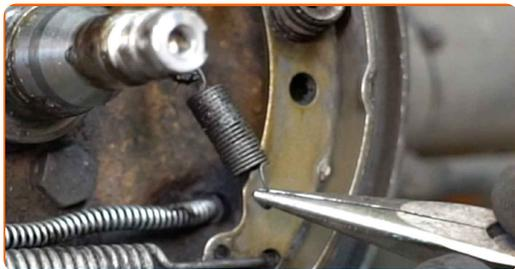
**13** Rimuovere la molla di ritorno superiore delle ganasce del freno. Usa delle pinze a becchi lunghi.
