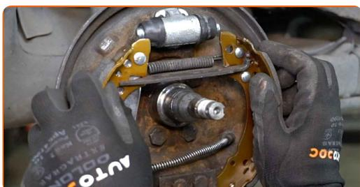
**23** Reinstallare la piastrina ferma-ganasce del freno. Utilizzare un compressore per molla di ritenzione della ganaschia del freno.
