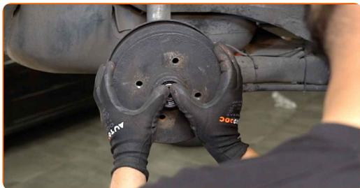
**11** Pulisci la sede di montaggio del cuscinetto del mozzo. Pulisci il mozzo. Usa un detergente spray multiuso.
