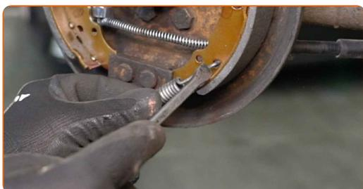
**25** Installare la molla di fermo. Usa delle pinze a becchi lunghi.
