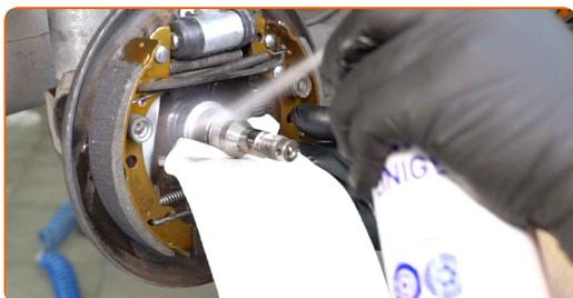
**28** Monta il freno a tamburo assemblato con il cuscinetto del mozzo ruota.
