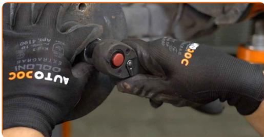
**10** Rimuovi il tamburo dei freni montato con il cuscinetto del mozzo ruota.
