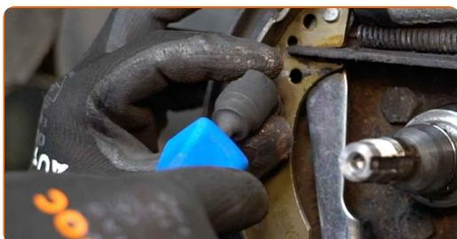
**15** Comprimere il cilindro della ruota. Usa le pinze per pompa ad acqua.
