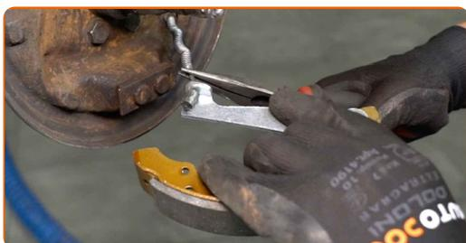
**21** Installare la leva di regolazione della ganaschia del freno.
