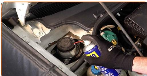
**4** Allenta gli elementi di fissaggio superiori del supporto dell'ammortizzatore. Utilizza una chiave a bussola N°13. Usa una chiave a cricchetto.
