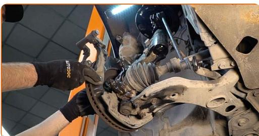
**17** Pulire l'elemento di fissaggio del disco del freno. Usa una spazzola metallica. Usa lo spray WD-40.
