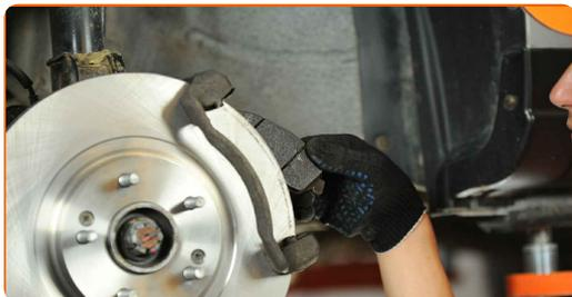
**28** Tratta con del prodotto il pistone della pinza freno. Usare una spazzola pulente in nylon. Usa un pulitore freni.
