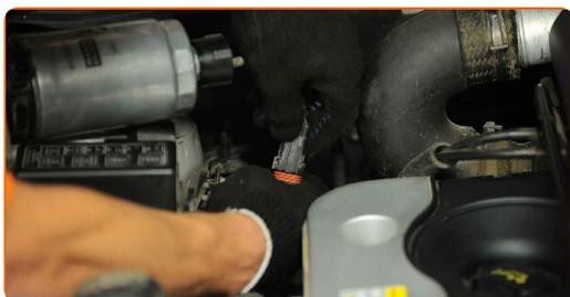
**16** Avvitare i bulloni di fissaggio della staffa del filtro carburante. Utilizza una chiave combinata N°19.
