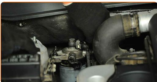
**19** Collega il connettore del sensore di pressione carburante.
