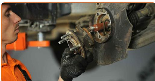
**22** Pulire la sede di montaggio del mozzo della ruota. Usa un detergente spray multiuso.
