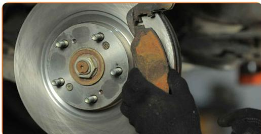
**13** Pulisci gli elementi di fissaggio del supporto pinza freno. Usa una spazzola metallica. Usa lo spray WD-40.
