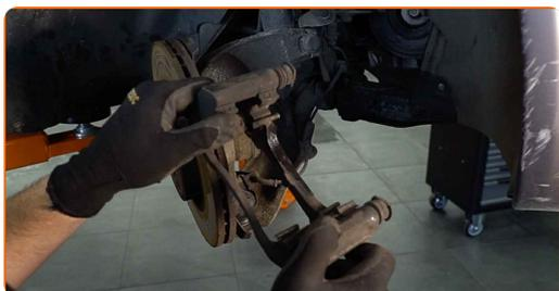
**16** Pulisci gli elementi di fissaggio del disco freno. Usa una spazzola metallica. Usa lo spray WD-40.
