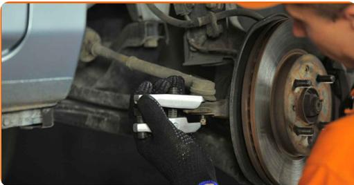
**11** Pulire il dado di bloccaggio che collega la testa del tirante col tirante. Usa una spazzola metallica. Usa lo spray WD-40.
