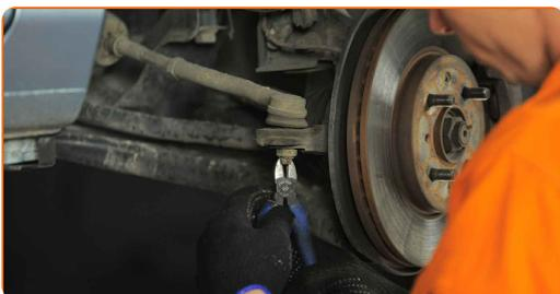
**8** Pulisci l'elemento di fissaggio che collega le testine tiranti al fuso a snodo. Usa una spazzola metallica. Usa lo spray WD-40.
