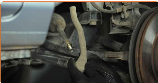
**14** Pulisci le sedi di montaggio delle testine tiranti dello sterzo. Usa una spazzola metallica. Usa lo spray WD-40.
