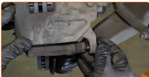
**40** Serra gli elementi di fissaggio della pinza del freno. Utilizza una chiave combinata N°17. Utilizza una chiave a bussola N°13. Usa una chiave dinamometrica. Serralo fino allo coppia di torsione di 35 Nm.
