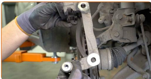
**20** Pulisci gli elementi di fissaggio del disco freno. Usa una spazzola metallica. Usa lo spray WD-40.
