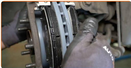
**38** Installare la pinza del freno e fissarla.
