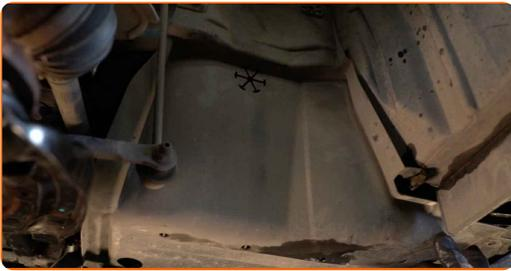
**17** Installa e serra gli elementi di fissaggio del parasassi del passaruota.
