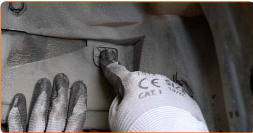
**18** Serra gli elementi di fissaggio del coperchio inferiore della coppa dell'olio. Usa un cacciavite Phillips.
