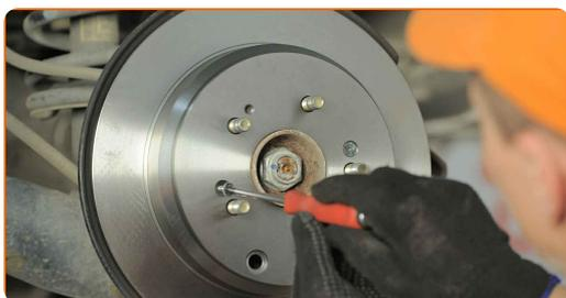
**22** Muovi le ganasce del freno di stazionamento contro il tamburo. Usa un giravite piatto.
