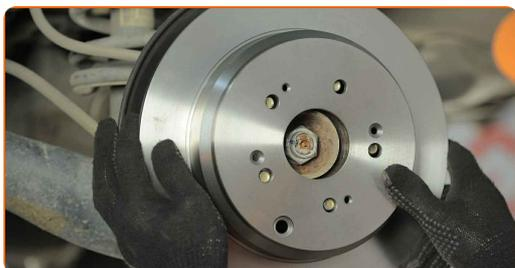
**21** Serrare l'attacco del disco freno. Usa un cacciavite Phillips. Usa una chiave dinamometrica. Serralo fino allo coppia di torsione di 9 Nm.
