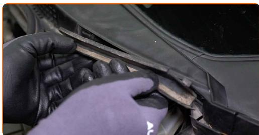
**32** Installa la guarnizione griglia sottoparabrezza.
