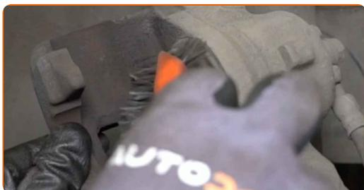
**18** Premere il pistone della pinza del freno. Usa un arretratore per pistoncini freni a disco.
