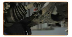
Svita gli elementi di fissaggio che collegano il tirante della barra stabilizzatrice alla barra. Utilizza una chiave combinata N°14 (2 pezzi).
