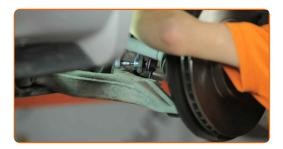
Tratta con del prodotto l'elemento di fissaggio che collega la testina tirante al fuso a snodo. Usa il grasso al rame.
