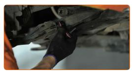
Installare l'elemento che fissa l'asta allo stabilizzatore e serrarlo. Utilizza una chiave combinata N°14. Usa una chiave HEX N.H6. Usa una chiave dinamometrica. Serralo fino allo coppia di torsione di 39 Nm.
