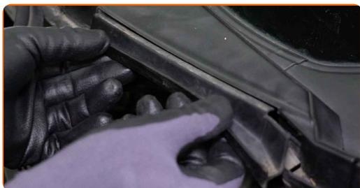
**32** Installa la guarnizione griglia sottoparabrezza.
