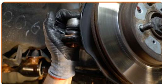
**16** Avvita il dado di serraggio che collega le testine tiranti dello sterzo al fuso a snodo. Utilizza una chiave a bussola N°17. Usa una chiave a cricchetto.
