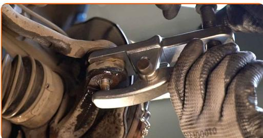
**10** Misura e memorizza la posizione precisa del giunto sferico sulla barra di accoppiamento, oppure conta il numero di giri completi al fine di evitare il disallineamento durante il montaggio successivo. Usa un calibro a corsoio.
