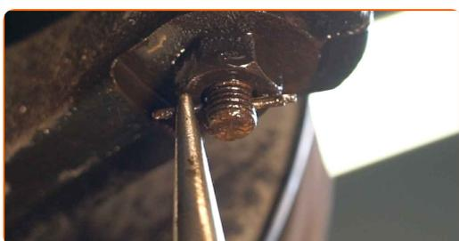
**8** Svitare il dado di attacco del gambo al fuso a snodo. Utilizza una chiave a bussola N°17. Usa un giramaschi.
