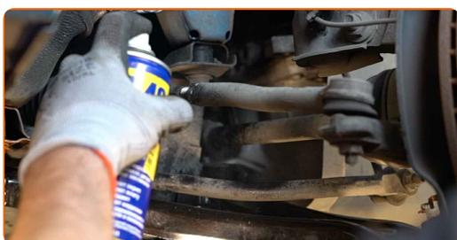
**7** Rimuovere il semicono che fissa il perno di montaggio della testa barra comando sterzo. Usa un piede di porco. Usa delle pinze a becchi lunghi.
