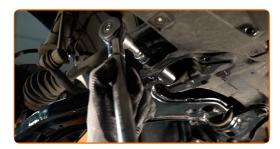
Serra gli elementi di fissaggio posteriori del braccio di controllo. Utilizza una chiave a bussola N°19. Usa una chiave dinamometrica. Serralo fino allo coppia di torsione di 93 Nm.
