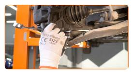
Scollegare il braccio inferiore dal fuso a snodo. Usa un estrattore del giunto sferico.
