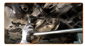
Rimuovi l'elemento di fissaggio posteriore del braccio di sospensione. Utilizza una chiave a bussola N°19.
