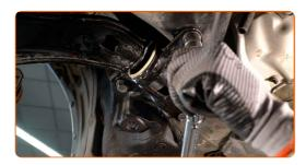
Serra gli elementi di fissaggio al giunto sferico. Utilizza una chiave combinata N°22. Usa una chiave dinamometrica. Serralo fino allo coppia di torsione di 65 Nm.
