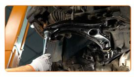
Avvita gli elementi di fissaggio posteriori che collegano il braccio di sospensione al sottotelaio. Utilizza una chiave a bussola N°19.
