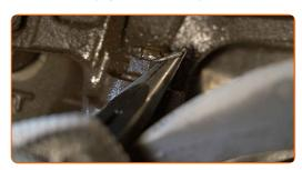
Svitare il perno che fissa il giunto sferico al fuso a snodo. Utilizza una chiave combinata N°19.
