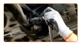
Svita gli elementi di fissaggio posteriori che collegano il braccio di sospensione al sottotelaio. Utilizza una chiave a bussola N°19. Usa un giramaschi.
