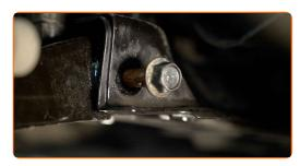
Installa gli elementi di fissaggio del braccio di controllo. Utilizza una chiave a bussola N°19.
