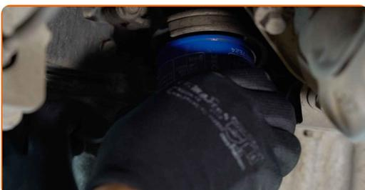
Sostituzione: olio motore e filtro - HONDA Accord I Hatchback (SJ, SY). I professionisti raccomandano:
