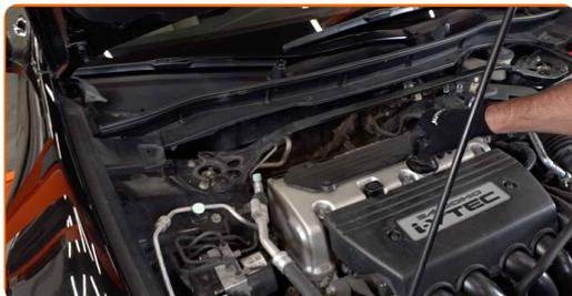
25 Far funzionare il motore per qualche minuto. Dopo che la spia di segnalazione luminosa della pressione dell'olio sarà spenta, spegni il motore.
