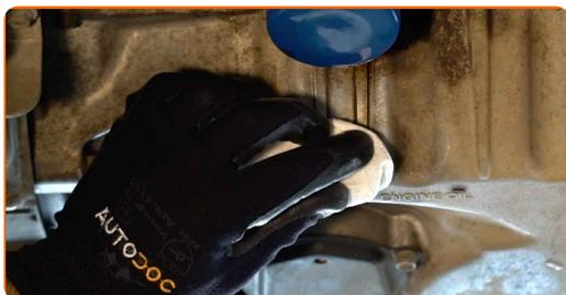
**17** Avvita il nuovo tappo di drenaggio e stringerlo. Utilizza una chiave a bussola N°17. Usa una chiave dinamometrica. Serralo fino allo coppia di torsione di 38 Nm.
