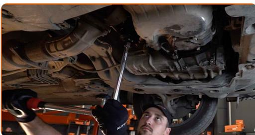
Sostituzione: olio motore e filtro - HONDA Accord I Hatchback (SJ, SY). AUTODOC raccomanda:
