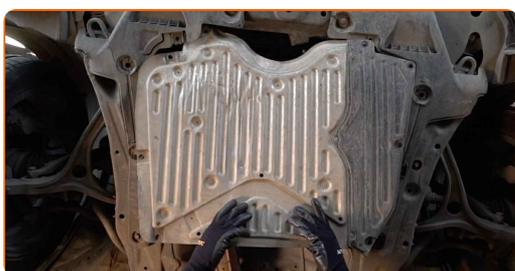
**19** Avvita gli elementi di fissaggio dell'insonorizzazione inferiore. Utilizza una chiave a bussola N°10. Usa una chiave a cricchetto.
