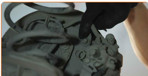
**7** Svitare l'attacco della staffa pinza freno. Utilizza una chiave a bussola N°E18. Usa una chiave a cricchetto.
