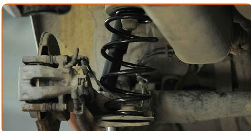
**18** Sostieni la traversa posteriore della sospensione. Usa un cric idraulico per trasmissione.
