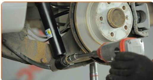
**22** Rimuovi il supporto da sotto la trave dell'asse posteriore.
