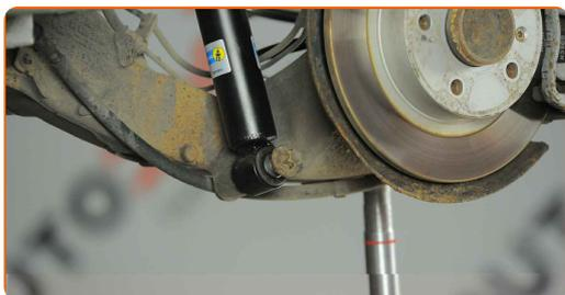
**20** Solleva il cric idraulico per trasmissione di 10-15 cm.
