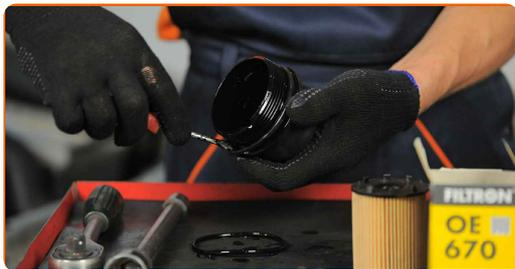
**18** Lubrifica la guarnizione di gomma del filtro nuovo con una piccola quantità di olio fresco.
