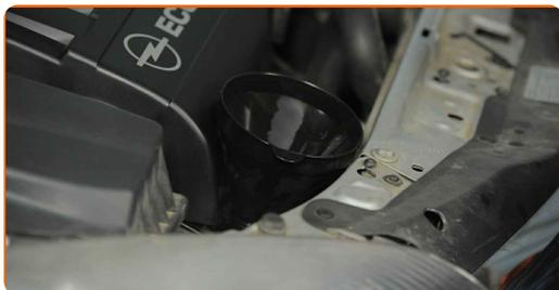
**25** Versa l'olio nel motore attraverso serbatoio. Quantità di olio richiesta:3.3 l.
