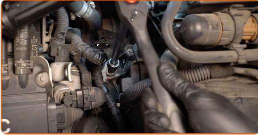
**22** Introduci l'imbuto. Versa dell'altro liquido di trasmissione nella scatola del cambio attraverso il foro di sfiato. Quantità di olio richiesta: 1.6 l.
