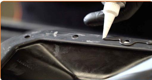
**16** Tratta con del prodotto la sede di montaggio della vaschetta del liquido di trasmissione. Utilizza un solvente e diluente.
