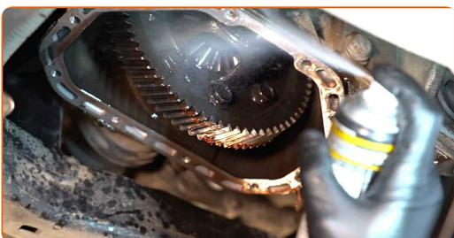
**13** Rimuovi la guarnizione della vaschetta del liquido di trasmissione. Usa un raschietto per sigillante.
