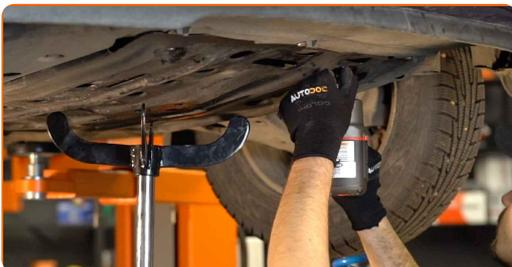
Sostituzione: olio del cambio manuale - Opel Astra G F48. AUTODOC raccomanda:
