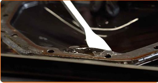
**14** Pulisci la sede di montaggio della guarnizione della vaschetta del liquido di trasmissione. Usa una spazzola metallica. Utilizza un solvente e diluente.
