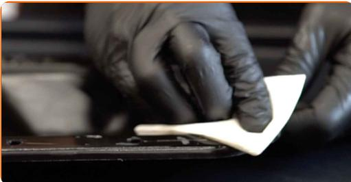
**15** Applica un sigillante alla sede di montaggio della guarnizione della vaschetta del liquido di trasmissione. Installa la guarnizione nuova della vaschetta del liquido di trasmissione.
