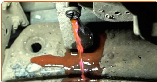
**Sostituzione: termostato refrigerante - FORD Transit Tourneo (FC\_ \_).**
