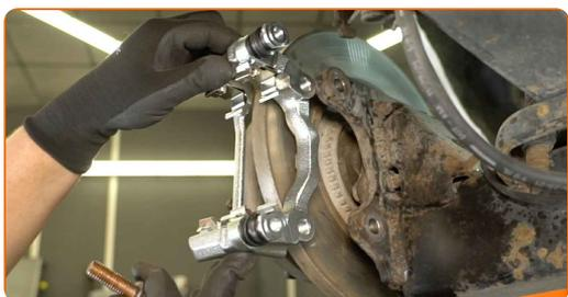
23 Installare e avvitare i bulloni di fissaggio.
