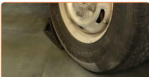
4 Allentare i dadi delle ruote. Utilizzare una chiave a bussola ad impatto per ruote da 21 mm. Utilizzare un giramaschi.
