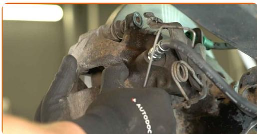
Sostituzione: staffa di una pinza freno - FORD Transit Mk7 Van (V363).
