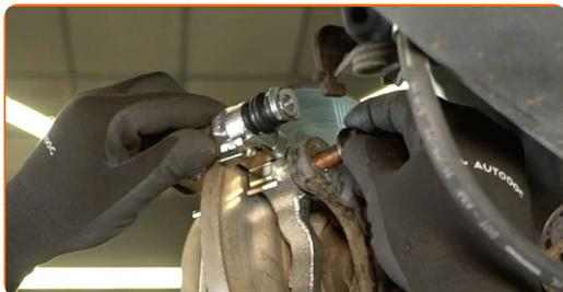
24 Serrare gli elementi di fissaggio del supporto della pinza del freno. Utilizzare una chiave a bussola da 15 mm. Utilizzare una chiave dinamometrica. Coppia di serraggio: 115 N·m.
