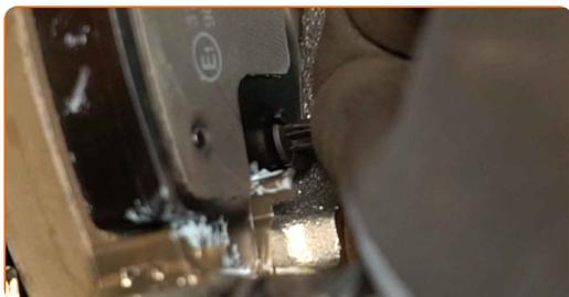
27 Installare la pinza del freno.
