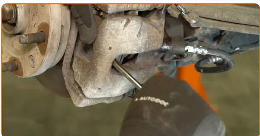
10 Svitare gli elementi di fissaggio della pinza del freno. Utilizzare una chiave combinata da 13 mm.
