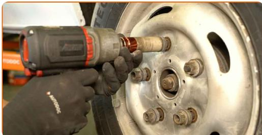
34 Rimettere il veicolo a terra e serrare i dadi della ruota seguendo un ordine incrociato. Utilizzare una chiave a bussola ad impatto per ruote da 21 mm. Utilizzare una chiave dinamometrica. Coppia di serraggio: 200 N·m.
