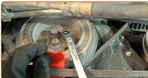
**3** Rimuovere la cinghia Poly-V dell'alternatore ruotando la puleggia dell'albero a gomiti. Utilizzare uno strumento di rimozione/montaggio della cinghia elastica. Utilizzare una leva di montaggio. Utilizzare una chiave combinata da 15 mm.
