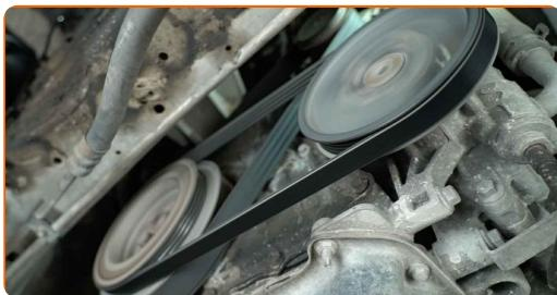
Sostituzione: cinghia poly-V - FORD Transit Mk7 Camion pianale / Telaio (V363). AUTODOC raccomanda:
