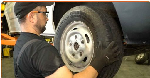
**Sostituzione: staffa di una pinza freno - FORD Transit Mk7 Bus (V363).**
