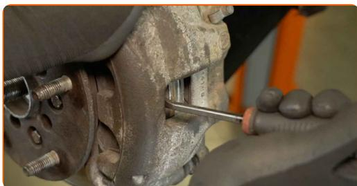
9 Pulire gli elementi di fissaggio della pinza del freno. Utilizzare una spazzola metallica. Utilizzare lo spray WD-40.
