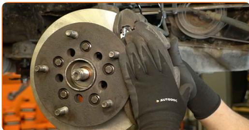
24 Installare i bulloni di fissaggio.
