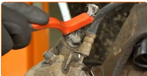
10 Svitare gli elementi di fissaggio della pinza del freno. Utilizzare una chiave combinata da 21 mm. Utilizzare una chiave a bussola da 15 mm. Utilizzare una chiave a cricchetto.
