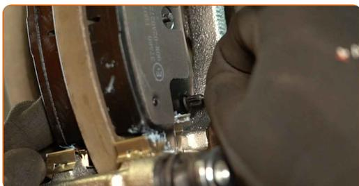
22 Installare la pinza del freno.
