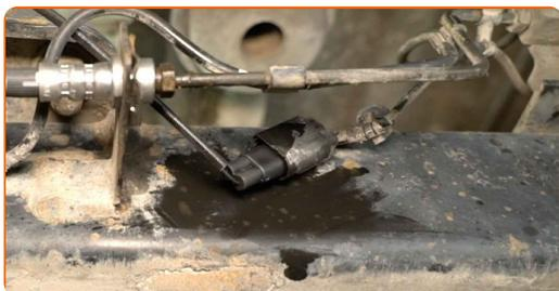
20 Fissare il cavo del sensore di usura delle pastiglie dei freni.
