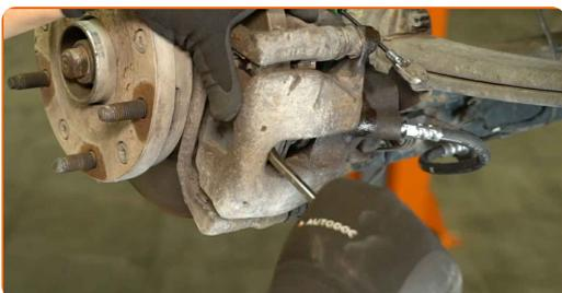
10 Svitare gli elementi di fissaggio della pinza del freno. Utilizzare una chiave combinata da 21 mm.
