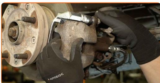
23 Installare i bulloni di fissaggio.
